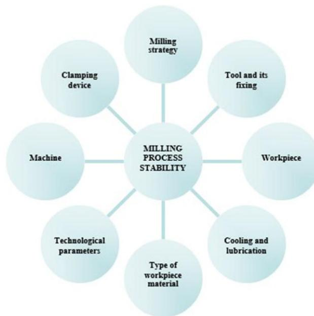
**Fig. 1. Factors affecting milling process stability (Płodzień & Żyłka, 2013)**
