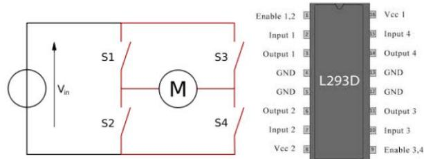
Fig. 3. L293D motor driver module
